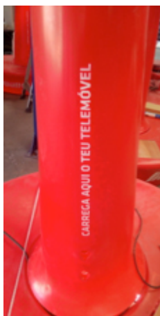
Fig. 5 : Marquage avec stencil à usage unique et rouleau à laque
